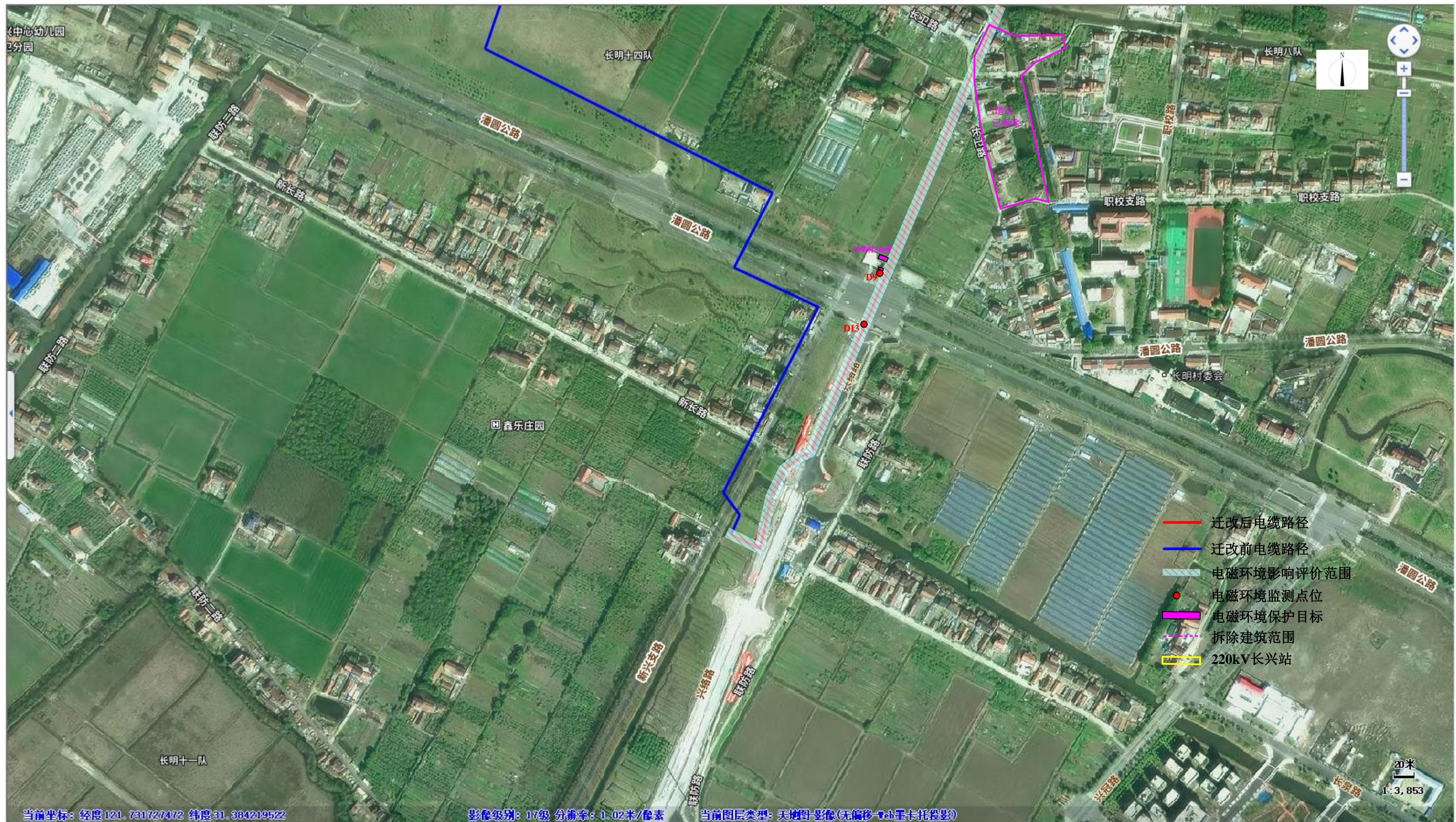
附图4-2: 电缆路径示意图2 (含电磁影响评价范围及电磁环境监测点位)
